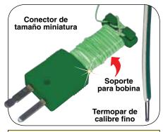
El soporte para bobina proporciona una manera conveniente de almacenamiento de los termopares.
