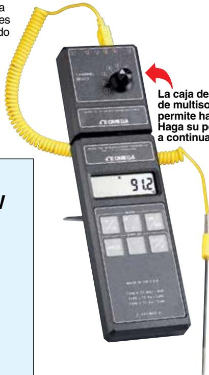
La caja de distribución de multisonda HH20SW permite hasta 6 sondas. Haga su pedido a continuación.
