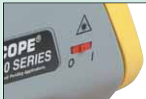
Interruptor de alimentación del láser
