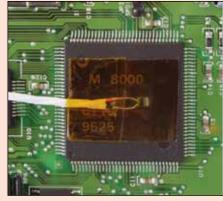
El sensor autoadhesivo es ideal para la colocación "dirigida" en superficies curvas o planas. Una vez posicionado, puede utilizarse "tal como está" para medir temperaturas en aplicaciones tales como herramientas de maquinaria, productos electrónicos, estructuras u otros lugares donde se deba controlar la temperatura.
